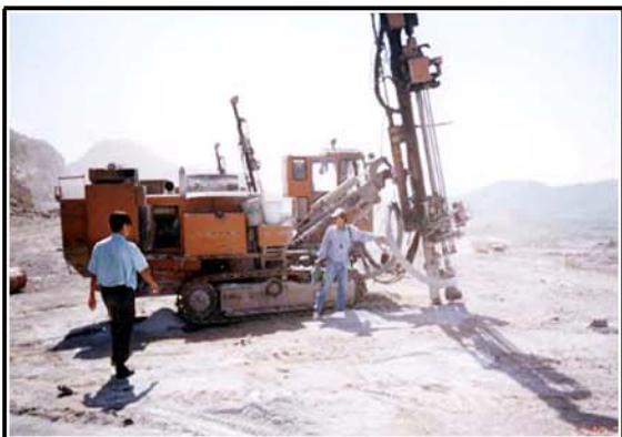
- รถเจาะระเบิดที่ติดตั้งระบบกำจัดฝุ่นขณะการเจาะ
